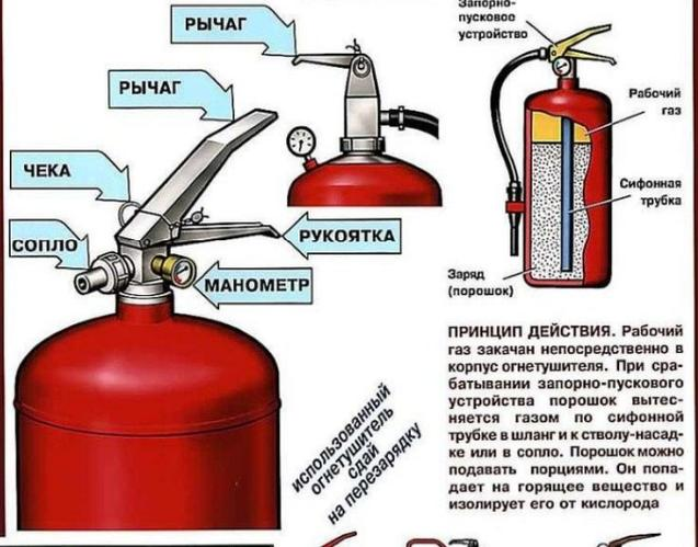
**ПРИНЦИП ДЕЙСТВИЯ.** Рабочий газ закачан непосредственно в корпус огнетушителя. При срабатывании запорно-пускового устройства порошок вытесняется газом по сифонной трубке в шланг и к стволу-насадке или в сопло. Порошок можно подавать порциями. Он попадает на горящее вещество и изолирует его от кислорода
