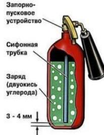
**ПРИНЦИП ДЕЙСТВИЯ** основан на вытеснении двуокиси углерода избыточным давлением. При открытии запорно-пускового устройства CO<sub>2</sub> по сифонной трубке поступает к раструбу и из сжиженного состояния переходит в твердое (снегообразное). Температура резко (до -70 °С) понижается. Углекислота, попадая на горящее вещество, изолирует его от кислорода
